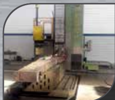
Alesatrice Mecof montante mobile da 8 metri, 2 metri di altezza di lavoro con tavola girevole
